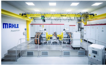
Auf dem E-Motoren-Prüfstand in Fellbach werden E-Antriebe unter realen Bedingungen getestet.
