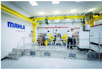
マーレの e テストベンチは、電気自動車の安全性と信頼性の保証するための電動駆動システムを試験します。
