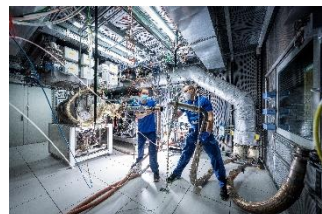
Viele Kernkompetenzen von MAHLE zählen auf das Thema Wasserstoff ein. Hier prüfen Mitarbeiter Kühlungssysteme für den Einsatz in Brennstoffzellenfahrzeugen.
