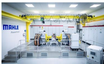
Unter Realbedingungen werden in Fellbach bei Stuttgart E-Antriebe geprüft.
