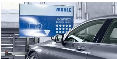
Mit dem MAHLE TechPRO Digital ADAS sinkt der Zeitaufwand für die Kalibrierung auf unter eine Minute.
