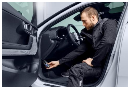
Die Daten des Ladegeräts und der OBD-Schnittstelle fließen im finalen Messbericht zusammen.
