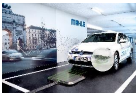
MAHLE hat für das induktive Laden ein Positioniersystem entwickelt, mit dem ein E-Fahrzeug exakt über der Ladespule im Boden ausgerichtet werden kann.
