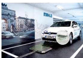
MAHLE desarrolla un sistema de posicionamiento para carga inalámbrica inductiva que permite posicionar un vehículo eléctrico exactamente encima de la bobina de carga en el suelo.
