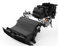
Diese thermische Architektur für batterieelektrische Fahrzeug (BEV) steigert die Energieeffizienz und verringert den Stromverbrauch des elektrischen Kompressors um 15 bis 20 Prozent
