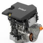
IAA presentación mundial: el sistema de ampliación de autonomía de MAHLE consiste en un generador de alta tensión altamente eficiente accionado por un pequeño motor de combustión interna
